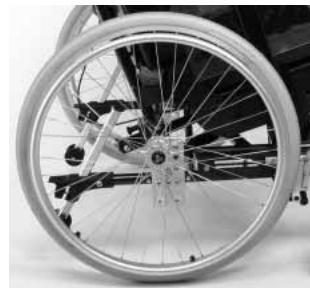
Grazie all'estensione del telaio integrata è possibile migliorare la stabilità della carrozzina e le caratteristiche di guida. Allentare le viti (1) per allungare il telaio. Al termine della regolazione assicurarsi che le viti siano strette (vedere il capitolo Coppie di serraggio).
