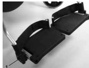
Lorsque la vis (1) est desserrée, vous pouvez avancer ou reculer la plaque. Après avoir procédé à vos réglages, vérifiez toujours d'avoir bien revisé toutes les vis (voir la section sur la force de torsion). Veillez à toujours conserver l'écart minimum de 2,5 cm avec le sol.
