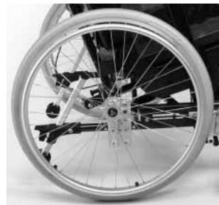
Durch die eingebaute Rahmenverlängerung kann die Stabilität des Rollstuhls und die Fahreigenschaften verbessert werden. Durch Lösen der Schrauben (1) kann der Rahmen entsprechend verlängert werden. Achten Sie darauf, dass nach Umbauarbeiten alle Schrauben fest angezogen sind (siehe Seite Anzugsmomente).
