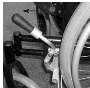
Die Feststellbremsen sind nicht als Betriebsbremsen ausgelegt. Während der Fahrt die Bremsen nicht betätigen. Bremsen Sie immer mit Hilfe der Greifringe.
