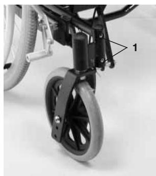
Pour compléter le réglage, vous pouvez également régler le coussinet à l'intérieur même de la fixation. Revissez les vis.
