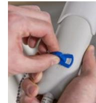
Durch Drehen des Schlüsselschalters in die verschiedenen Schalterstellungen ist die Einschränkung der Handschalterfunktionen möglich.
